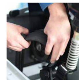
Einfacher Riemenwechsel am Mischwerk
